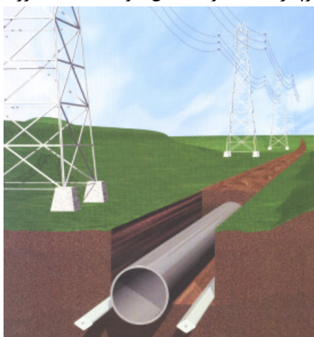
شکل ۲ - آند روی بکار گرفته شده در مجاورت سیستم انتقال نیرو
